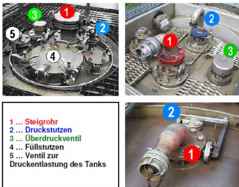
Abbildung A-05 – Armaturen im Dombereich eines Chemiekessels
