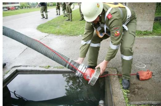
Der WTRM (Nr. 4) verlässt erst nach dem Befehl „Saugleitung zu Wasser!“ die Saugleitung (sonst „vorzeitiges Weglaufen des WTR“). Ist die Saugleitung an der TS vollständig angekuppelt, legt der MA den Kupplungsschlüssel rechts (in Richtung TS gesehen) neben dem Saugschlauch ab. Der MA kann nun die TS starten. Dem MA bleibt es überlassen, die TS händisch oder mittels Elektrostarter zu starten.
