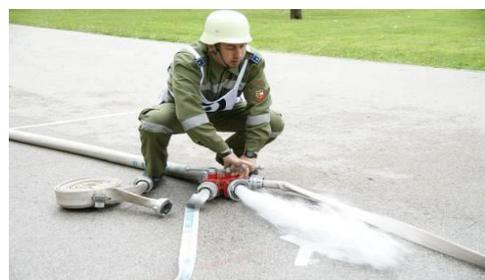
Sind beide Angriffsleitungen am Verteiler angekuppelt, gibt der Melder unverzüglich, mit über dem Kopf erhobener Hand, an den Maschinisten den Befehl „Wasser marsch!“ (sonst „verbotene Tätigkeit Nr. 3“).
