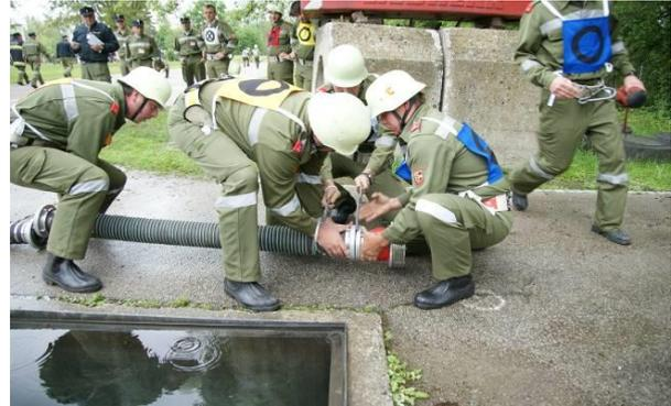
WTRF (Nr. 3) und STRF (Nr. 5) ziehen die Kupplungen mit dem Kupplungsschlüssel an, der von oben an den Rippen der Saugkupplung angesetzt werden muss (die Kupplungsschlüssel müssen zumindest auf der Saugkupplung vollständig in ihrer Form aufgesetzt werden - ein alleiniges „Aufschlagen“ oder flaches „Auflegen“ wird als „falsches Arbeiten“ bewertet).
