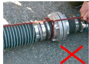
Erst nach dem Befehl des MA „Saugleitung zu Wasser“ ist die Saugerleine durch den WTRF (Nr. 3) am Haltepflock zu befestigen (sonst „vorzeitiges Befestigen der Saugerleine“). Jedoch kann der WTRF (Nr. 3) die Saugerleine am Haltepflock vorher anlegen. Erst danach verlässt der WTRF (Nr. 3) die Saugleitung (sonst „vorzeitiges Weglaufen vom WTR“).
