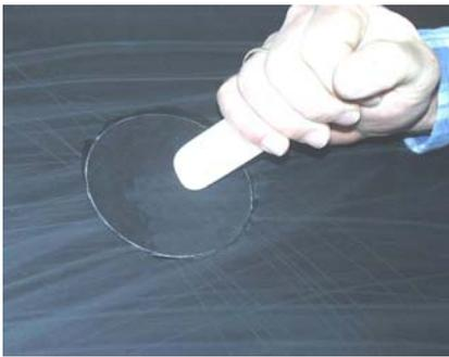
Den Flicken deckend auf die Schadstelle legen und mit einem stumpfen Gegenstand die gesamte Fläche mit einem hohen Druck anreiben.
